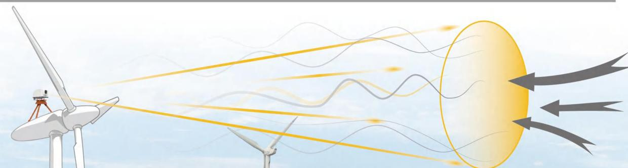
4Hz、4光束、10个距离同步测量
