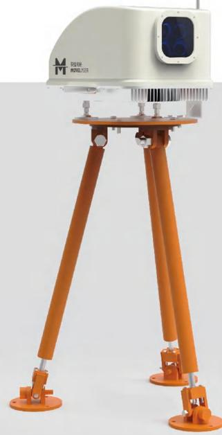
Molas NL 系列是公司针对风电客户智能化应用方案自主研制的机舱式测风激光雷达，是一种安装在风力发电机组机舱顶端的激光遥感测风装置。雷达采用相干探测体制，基于激光多普勒频移的原理，实现对风机叶轮前方 50m-200m/400m/750m 风矢量场的精确测量。
